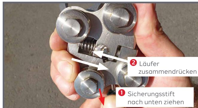
Nun den so geöffneten Läufer auf der Schiene einsetzen und loslassen. Der Fallschutzläufer sitzt fest auf der Alu-Führungsschiene und muss sich frei hin und her bewegen lassen.
