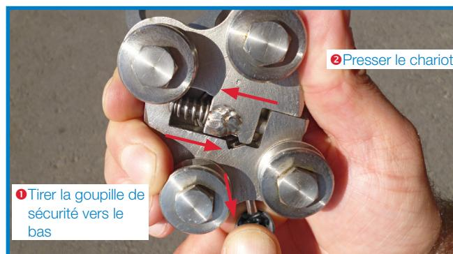
Placer le chariot ainsi ouvert sur le rail et relâcher la pression. Le chariot est fixé sur le rail de guidage en aluminium et doit pouvoir avancer et reculer sans gêne.
