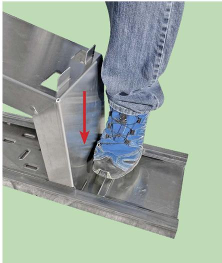
Sicherstellen, dass die GR-Modulstütze auf beiden Seiten eingeklickt ist!
